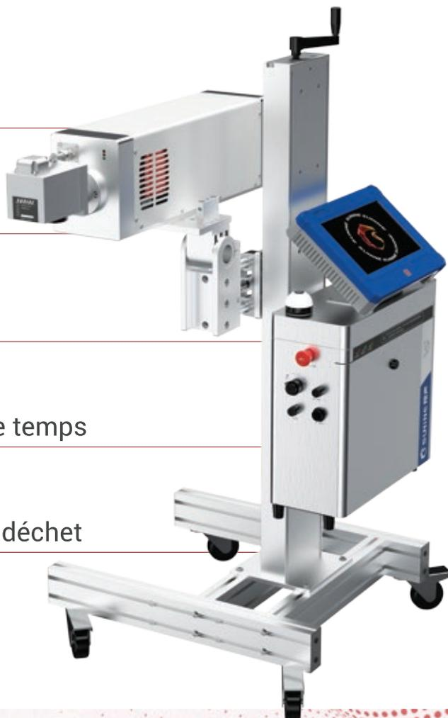
Le Laser FIBRE série RBK-F permet de marquer sur des produits à l'arrêt ou en défilement sur une ligne de production ou de conditionnement.
